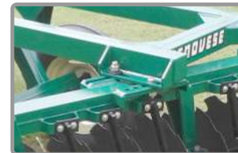
Correderas mixtas que evitan desplazamiento por desajuste.
