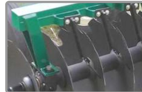
Limpiadiscos tipo pala, reforzados con soportes individuales.
