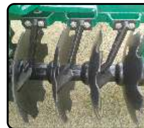
Limpia Discos tipo palas con soportes individuales.
