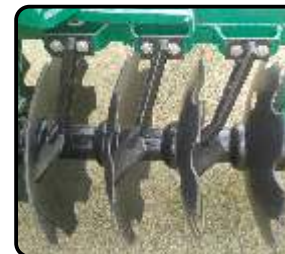
Limpia Discos tipo palas con soportes individuales.
