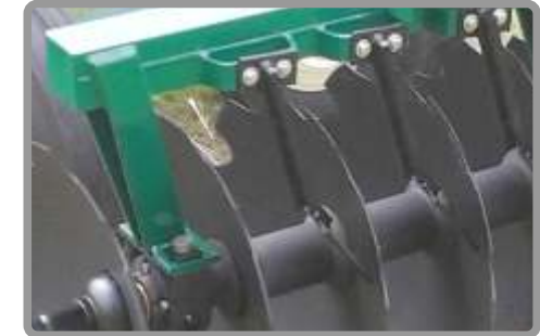
Limpiadiscos tipo pala, reforzados con soportes individuales.
